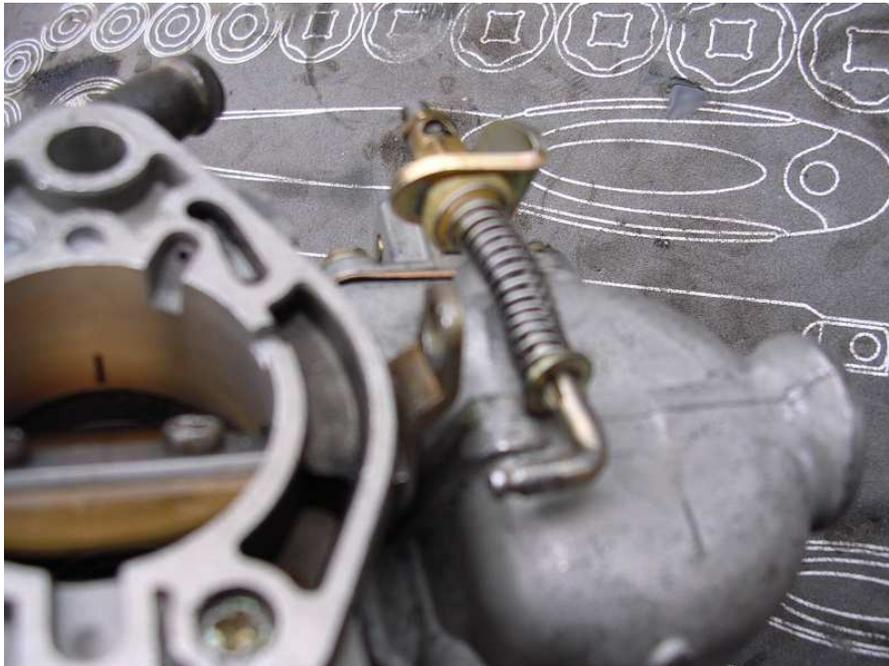
Il existe une solution pour réparer cela (Renault ne détaille pas cette pièce !). Elle consiste à souder une rondelle en fer d'un côté de la tige (vers le coude) et à passer la tige dans le trou de la patte en fer. Une fois en place il suffit alors de mettre une rondelle d'épaisseur de l'autre côté de la patte pour caler le tout puis de mettre un circlip dans la gorge de la tige pour maintenir le tout !
