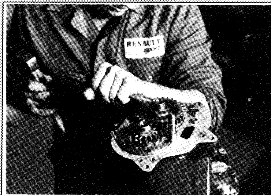
Arret des écrous d'arbre primaire et secondaire
