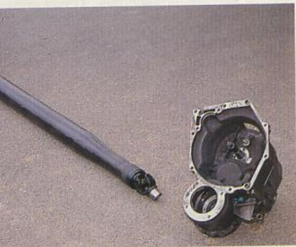
Pour ce prototype, Renault Sport a réalisé une boîte de vitesses spécifique qui est un chef-d'œuvre de compacité. Elle utilise une pignonerie Hewland. L'arbre de transmission est en carbone, comme sur l'Espace Quadra. Le moteur n'est pas disposé longitudinalement, comme sur la 21 Turbo de série, mais transversalement.
