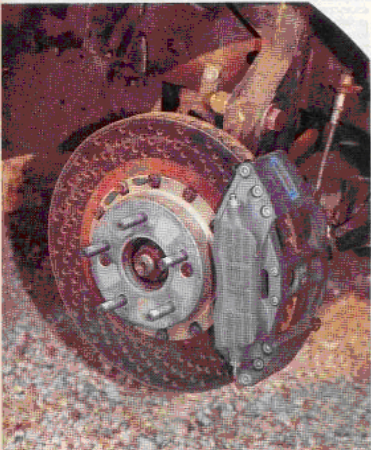
Le système de freinage à l'avant: disques de 315 mm de diamètre, étriers 4 pistons et plaquettes Ferodo.
