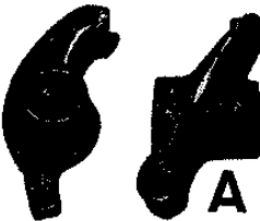
A. Culbuteur d'admission - B. Culbuteur d'échappement (Photo RTA)
