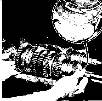
Dépose du train secondaire et du téton d'arrêt de la cage extérieure du roulement double (Photo RTA)
